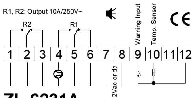
**Схема подключения терморегулятора LILYTECH ZL-6231A**
